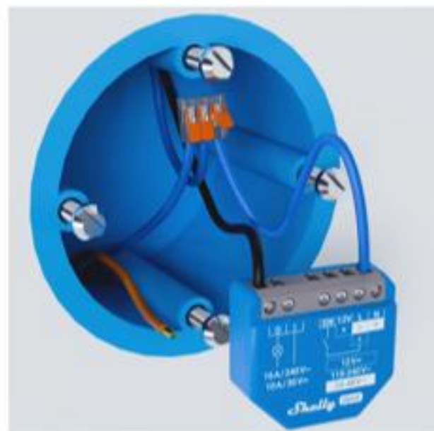
③负载线接入设备 O 端 零线接入 N 端
