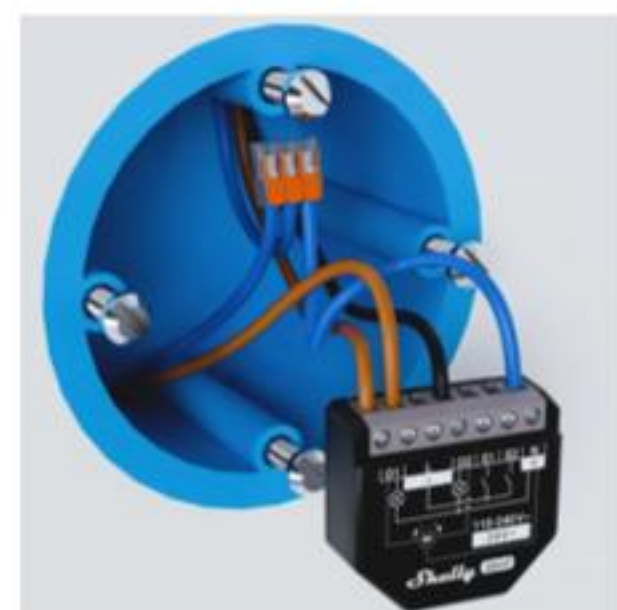
④零线接入设备N端子 火线接入L端
